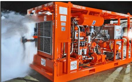
El sistema está sido diseñado y fabricado para su uso en Zona II - 3G (NEC 500 Clase 1 División 2). La conformidad de los sistemas es a través de la certificación ATEX\*\* de todos los componentes relevantes y la ignición de extensión.\*\*ATEX: Atmosphere EXplosible
